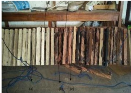
Fig. 3. Samples condition before bioassay (a) V. cofassus (b) C. inophyllum (c) D. indica (d) A. falcataria (e) Diospyros sp.
